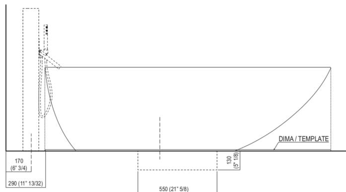
Per un corretto posizionamento del pozzetto e della rubinetteria è necessario utilizzare la dima in cartone con sagoma uguale al profilo superiore della vasca.
